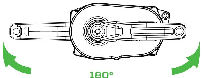
**009**\_À l'aide d'une clé Allen de 8 mm, vissez l'écrou de manivelle dans le filetage de l'axe. Veillez à ce que le filetage démarre correctement avant de le serrer à fond. Le boulon doit tourner librement et tirer la manivelle sur la première partie de la cannelure avec une résistance minimale.
