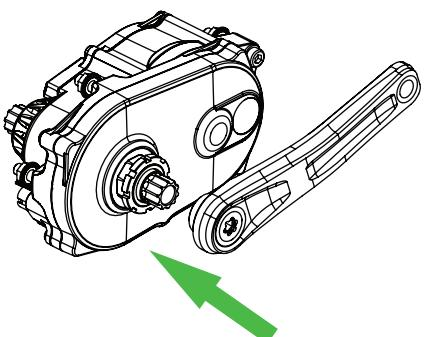
**005** À l'aide d'une clé Allen de 8 mm, vissez l'écrou de manivelle dans le filetage de l'axe. Faire attention de bien démarrer le filetage avant de le serrer à fond. L'écrou doit tourner librement et tirez la manivelle sur la première partie de la cannelure avec une résistance minimale.
