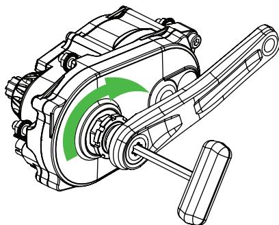
**006** Vissez complètement l'écrou de manivelle en insérant la manivelle sur la cannelure de l'axe. Plus la manivelle glisse loin sur la cannelure, plus il faudra de couple pour faire tourner l'écrou de manivelle. La manivelle s'arrêtera solidement contre l'épaulement de l'axe lorsqu'elle sera correctement positionnée. Couple de serrage recommandé pour l'écrou de manivelle: **50 N.m**
