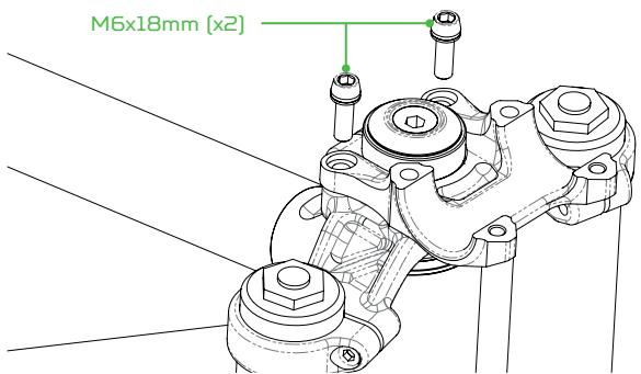
**002**\_Positionnez le cintre dans la position désirée et installez à la main les 2 vis intermédiaires de M6x45mm et serrez-les légèrement.
