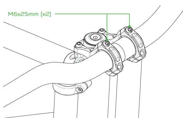
**003**\_Lorsque vous êtes satisfait de l'orientation du cintre, serrez les 2 vis des brides. Couple de serrage recommandé 9N.m. Serrez alternativement jusqu'à ce que le couple de serrage soit atteint.
