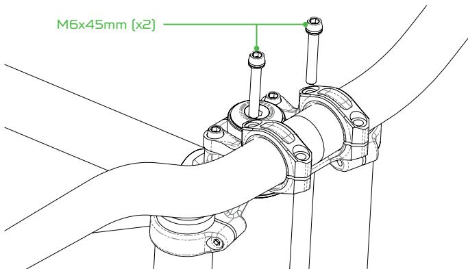
**003**\_Lorsque vous êtes satisfait de l'orientation du cintre, serrez alternativement en croix les 4 vis du té. Couple de serrage recommandé : 10-12N.m
